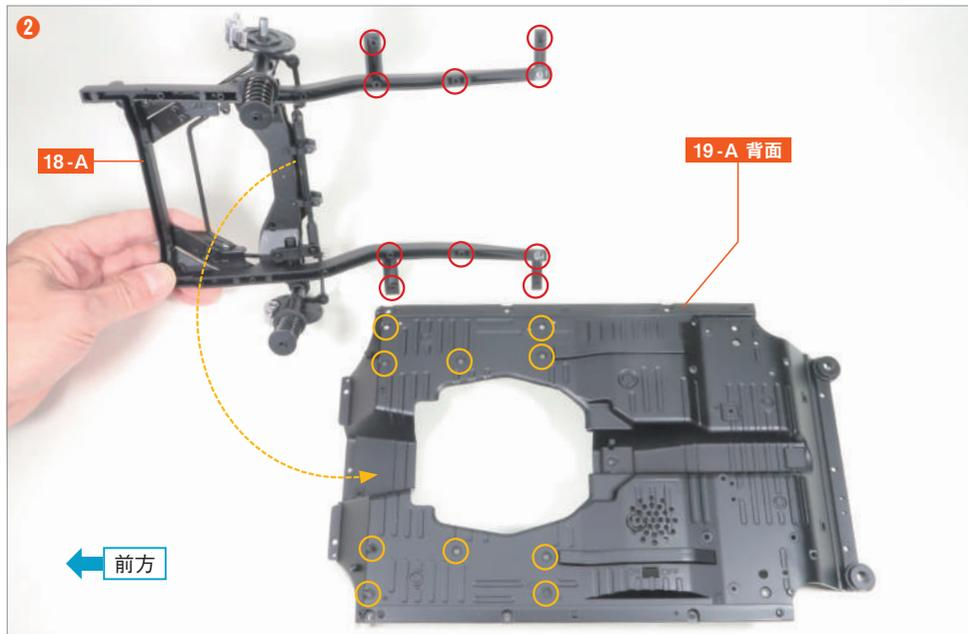
將車身淺盤型地板 19-A 翻轉，將前副車架 18-A 圈起的突起部分對齊嵌入地板 圈起的螺絲孔凹槽中。
