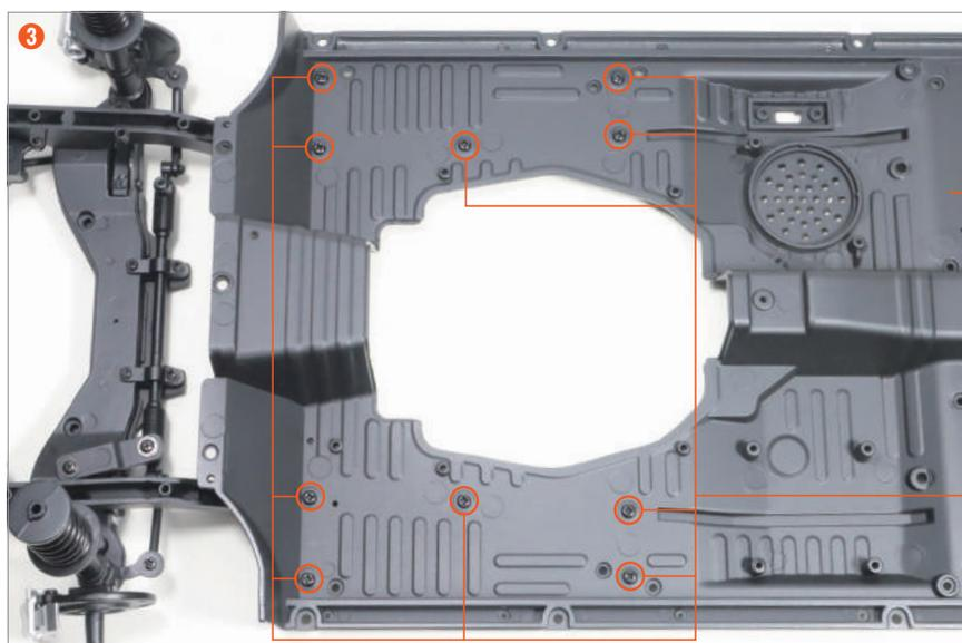
按住 18-A 以防止其脫落，將整個組件翻轉到正面，使用 AFM 螺絲 在 10 個位置進行固定。
