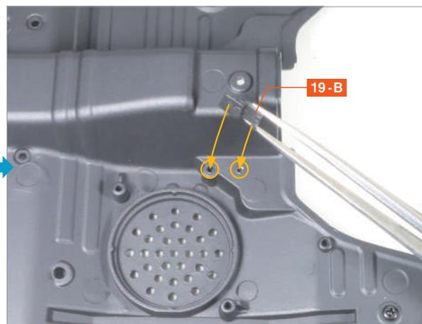
將線夾 19-B 突起部分插入 19-A 的洞孔，與螺絲孔對齊。
